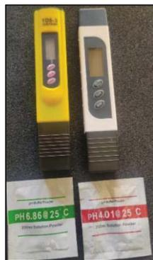
**Gambar 3. 5 Alat ukur suhu dan pH terkalibrasi**
