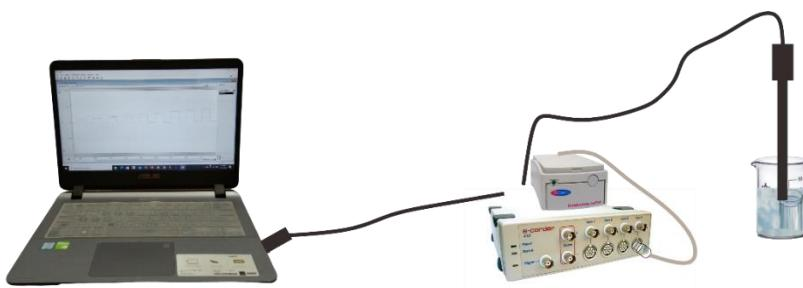
Gambar 2. 10 Intrumentasi konduktometer
