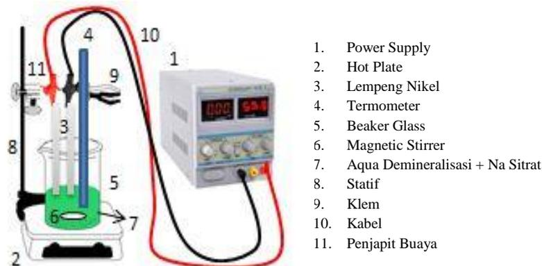
Gambar 3. 1 Skema sel elektrolisis nanopartikel Ni(OH)<sub>2</sub>
