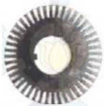
Gambar 3. 4 Konstruksi Jenis Rotor Kelas A [11]
