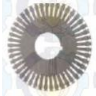
Gambar 3. 6 Konstruksi Jenis Rotor Kelas C [11]
