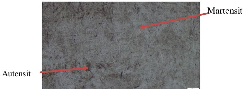
**Gambar 4.5** Pengamatan Struktur Mikro dengan Pembesaran 500x dengan *quenching*
