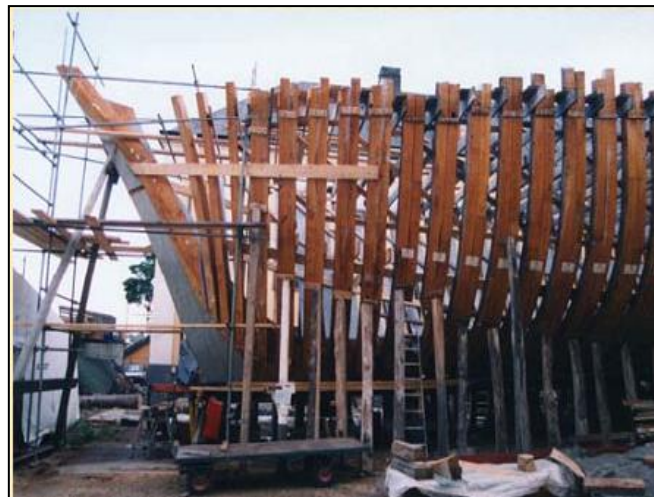
Gambar 2. 5 Konstruksi Linggi Haluan (Widodo, 1998)
