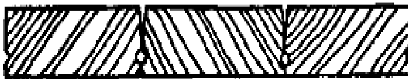
Gambar 2. 6 Bentuk Kampuh Papan (BKl Peraturan Tentang Kapal Kayu, 1996)
