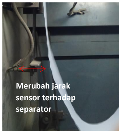
Gambar 5. 7 Mekanisme perubahan jarak sensor
