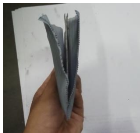
Gambar 4. 7 Separator tidak Terjahit dengan plat didalamnya
