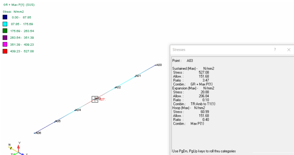
Gambar 5. 2. Hasil Stress Analysis pada Kapal Jenis Passenger
