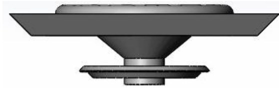
Gambar 3. 7 Penggabungan driver dan enclosure Hexahedron pada perangkat lunak Solidwork 2016
