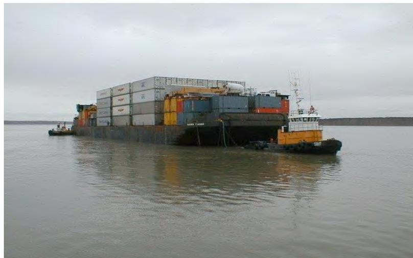
Gambar 2.5 Tongkang pengangkut kontainer (*Container Barge*)
