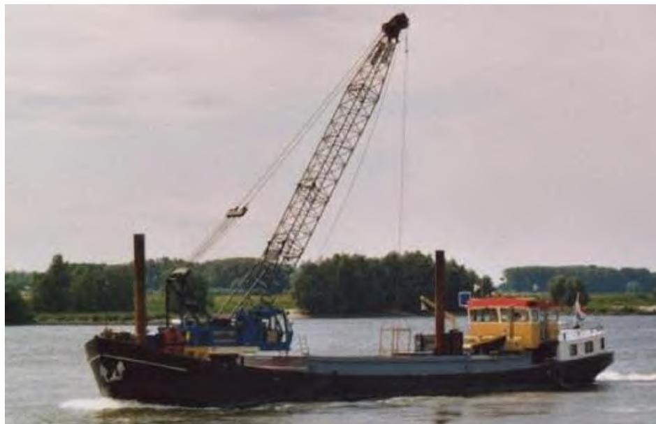
Gambar 2.7 Kapal dengan alat bongkar muat
