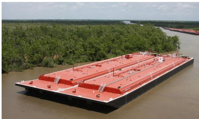
Gambar 2.2 Tongkang pengangkut minyak (*Oil Barge*)
