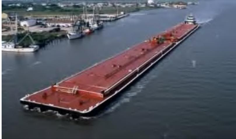
Gambar 2.3 Tongkang pengangkut cairan kimia (*Chemical Barge*)
