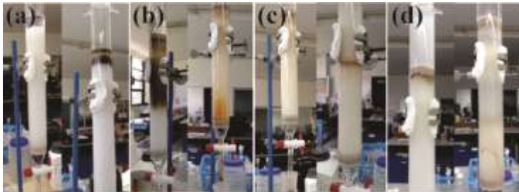
Gambar 4.2 Proses fraksinasi dengan kromatografi kolom (a) Preparasi kolom; (b) Elusi fraksi netral; (c) Elusi fraksi asam; (d) Elusi fraksi polar
