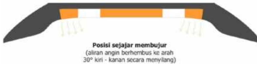
Gambar 56 potongan Sistem Penghawaan Pipa Turbulen
