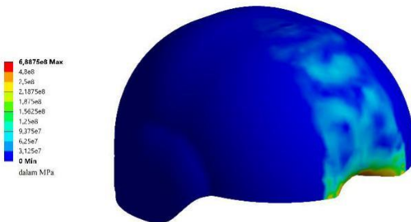
(a) Distribusi stress dengan penetrasi dari arah depan helm
