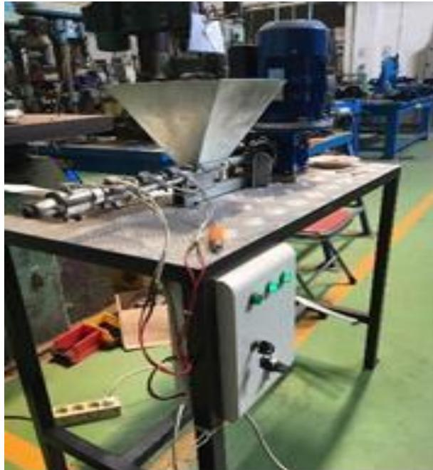
**Gambar 3.6** Mesin Ekstruder Tipe Single Screw
