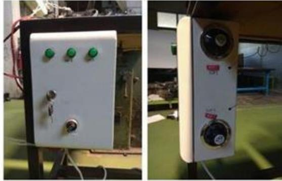
**Gambar 4.4** Control Panel pada Mesin Ekstruder Tipe Single Screw
