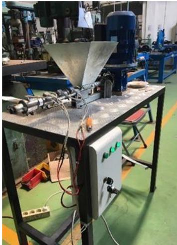
Pembuatan Biokomposit dilakukan menggunakan Mesin Ekstruder tipe single screw seperti gambar diatas.
