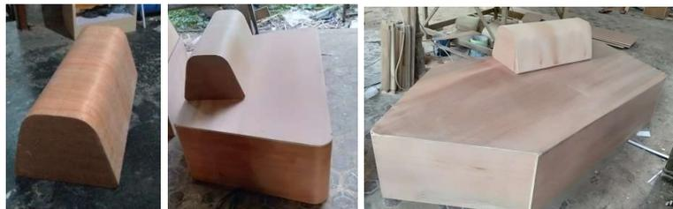
Gambar 5. 80 Proses pembentukan *model* bangku skala 1:1
