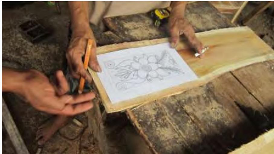
Gambar 5.15 Proses Penempelan Cetakan pada Bahan Mentah
