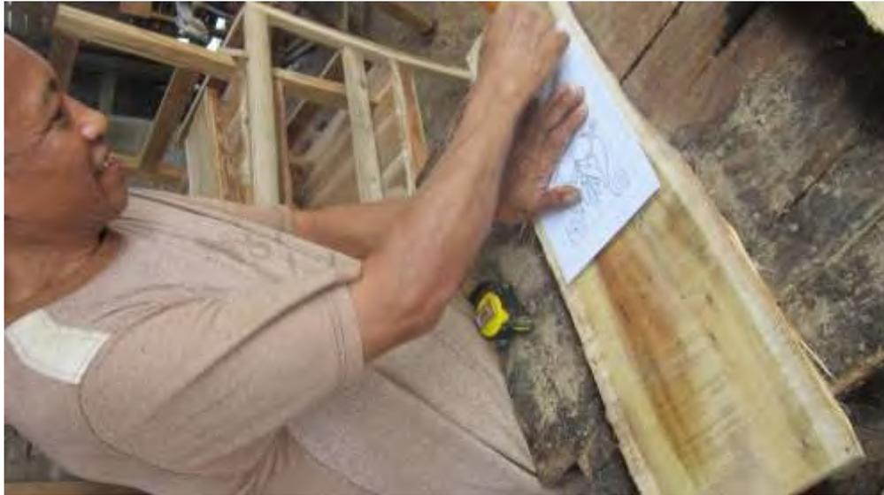
Gambar 5.16 Proses Penempelan Cetakan pada Bahan Mentah
