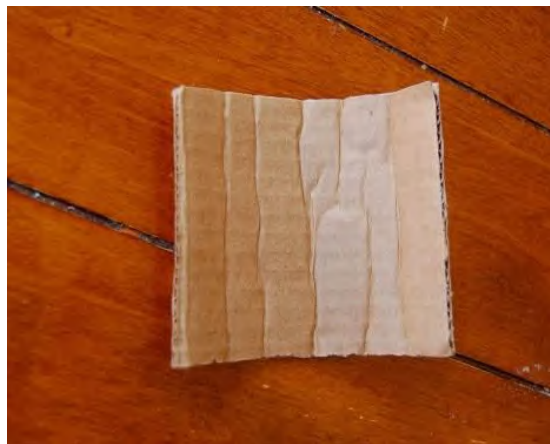
Gambar II. 21. Lipatan yang merusak permukaan kardus. Sumber: dok. Pribadi.
