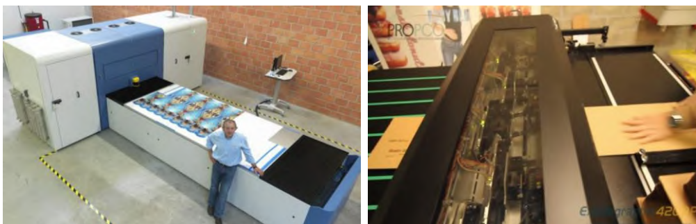
Gambar II. 42. Mesin print kardus (kiri) & proses print kardus (kanan). Sumber: dok pribadi.
