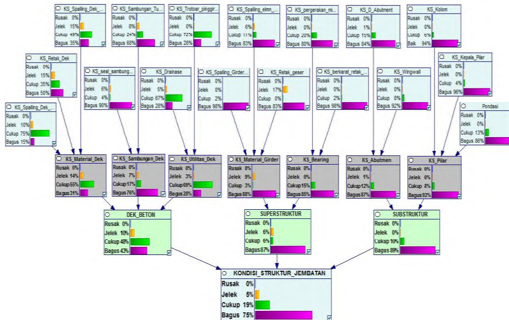
Gambar 5-3 Hasil prediksi penilain kondisi jembatan dengan 4 penetapan kondisi dan input penetapan kondisi rata-rata hasil laporan MnDoT 2015
