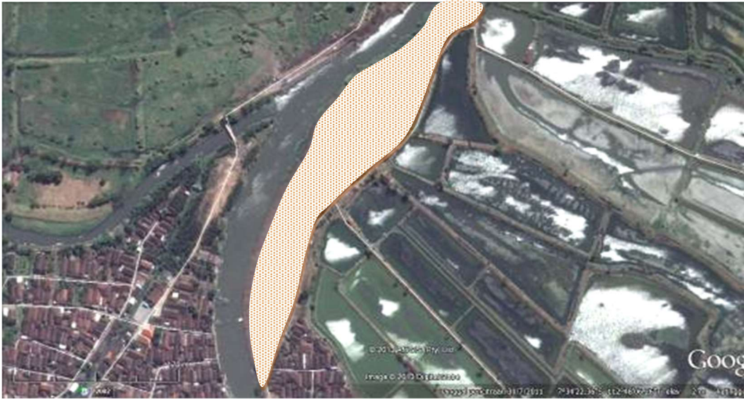
Gambar 4.5-2 Sedimentasi di Sungai Kedunglarangan
