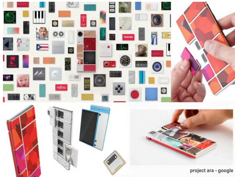
Gambar 2.5 Contoh Produk dengan Sistem Bus Modularity
