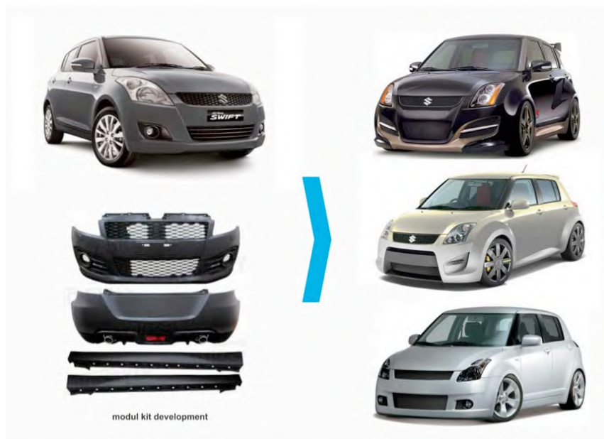
Gambar 2.5 Contoh Produk dengan Sistem Component Swapping Modularity (Engineering Design: A Systematic Approach)
