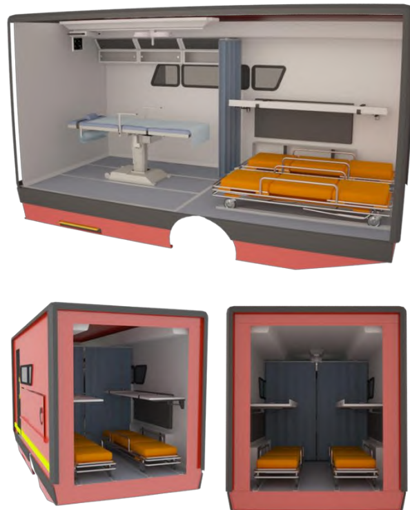
Gambar 6. 3 Layoutinterior pada kabin ambulans
