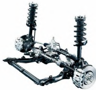
Gambar 6. 2 Suspensi pada Mercedes benz Sprinter
