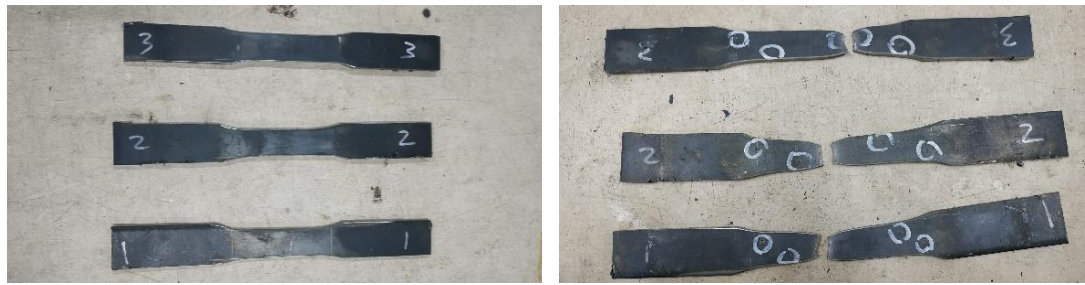
Gambar 3.3 Hasil Pengujian Tarik pelat SS400
