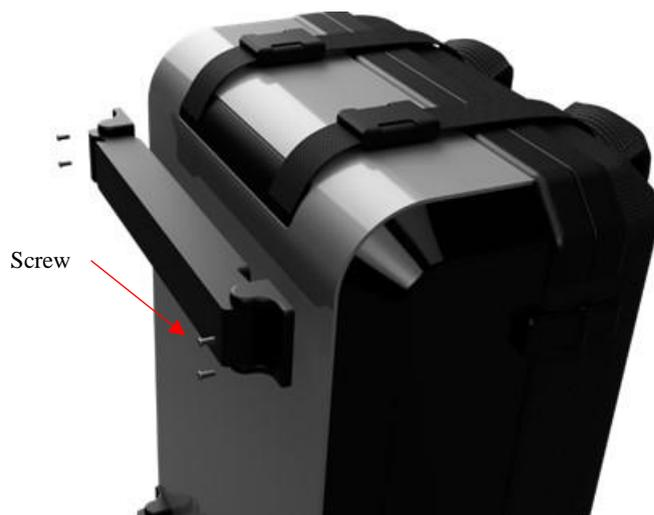
Gambar 5. 17 Pemasangan *Support Skid* pada *Storage Drone*
