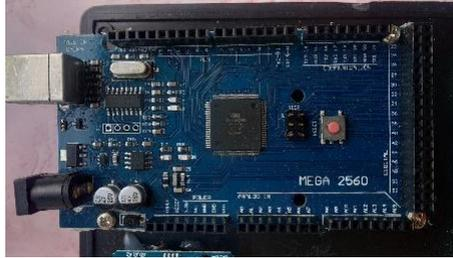
**Gambar 2.3. Mikrokontroler Arduino Mega 2560**
