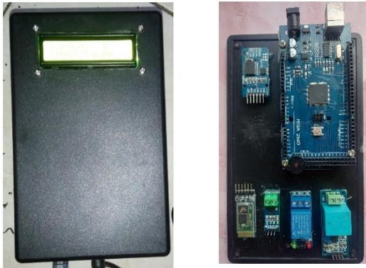
**Gambar 3.13** Fitur pada meter (kiri tampak depan dan kanan tampak dalam)
