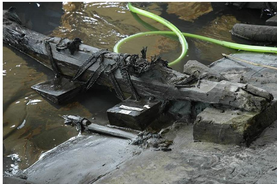
Gambar 2.15 Detil ikatan pada floor Kapal (dasar gading) dan tambuku
