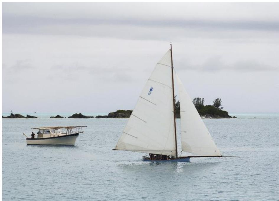
Gambar 2.24 Perahu *dinghy* dengan layar *bermuda* (Wikimedia Commons)
