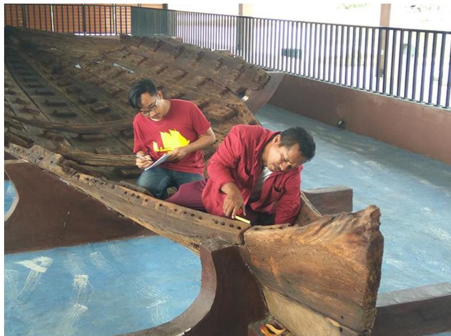
Gambar 2.17 Pengukuran Kapal oleh team dari Dept. Teknik Perkapalan FTK. ITS
