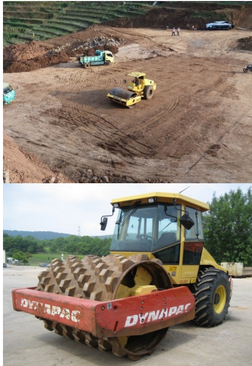
Gambar 2.6 Vibro roller dan Sheepfoot roller (Sumber : Dokumen Pribadi)
