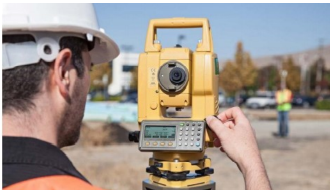
Gambar 4.7 Bidikan Lensa Ke Arah Prisma Yalon
