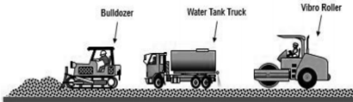
Gambar 4.67 Pemadatan menggunakan Bulldozer
