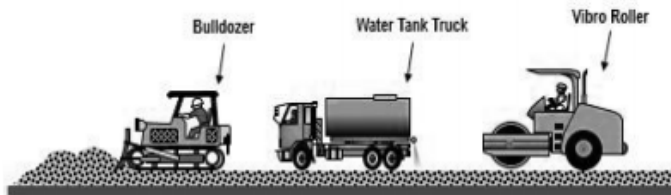
Gambar 4.64 Pemadatan menggunakan Bulldozer
