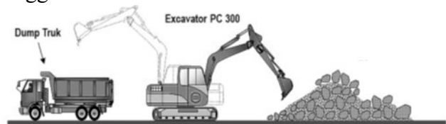
Gambar 4.68 Pengangkutan material Rip Rap dari Stockpile
