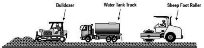
Gambar 4.60 Pemadatan menggunakan Sheepfoot Roller
