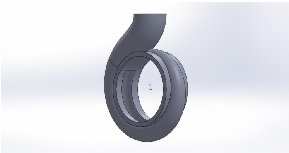
Gambar 4.8 Cutting untuk Alur Fluida pada Casing
