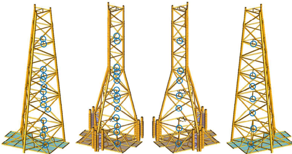
Gambar 4.12 Lokasi joint yang ditinjau pada bracing
