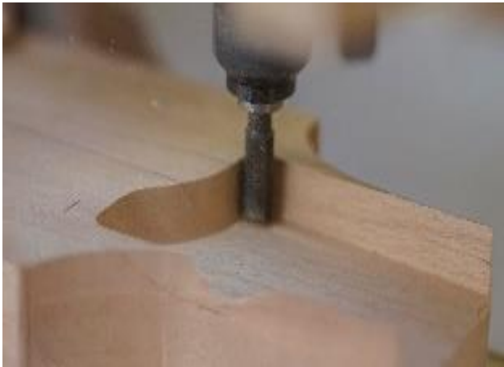
Lampiran 40 Proses CNC bodi gitar bentuk dasar 3 axis (Sumber : Penulis, 2020)
