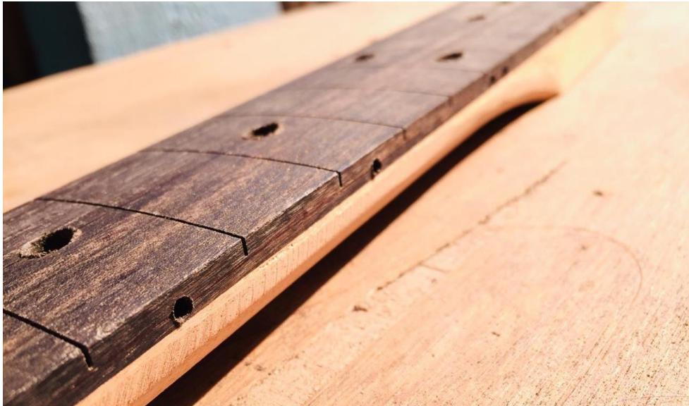
Lampiran 36 Pelubangan dot inlay dan fret line (Sumber : Penulis, 2020)
