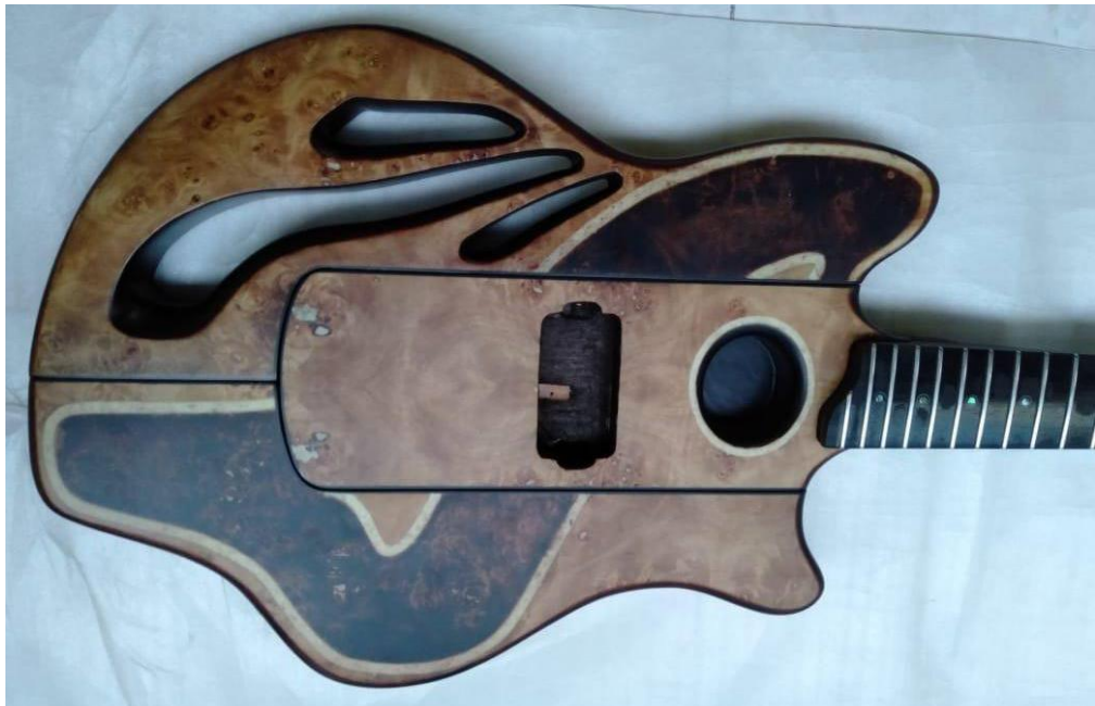
Lampiran 44 Modul gitar setelah di finishing menggunakan polyurethane (Sumber : Penulis, 2020)
