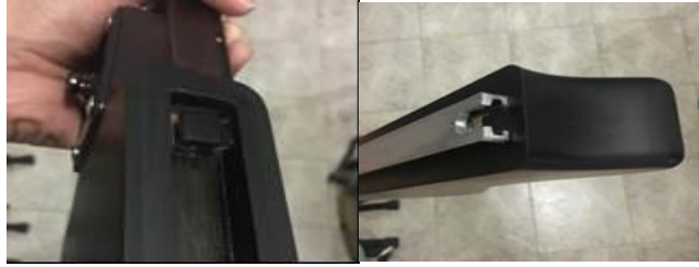
Gambar 5.0.33 Sistem rel Reverse T-Slot (Sumber : Penulis, 2020)
