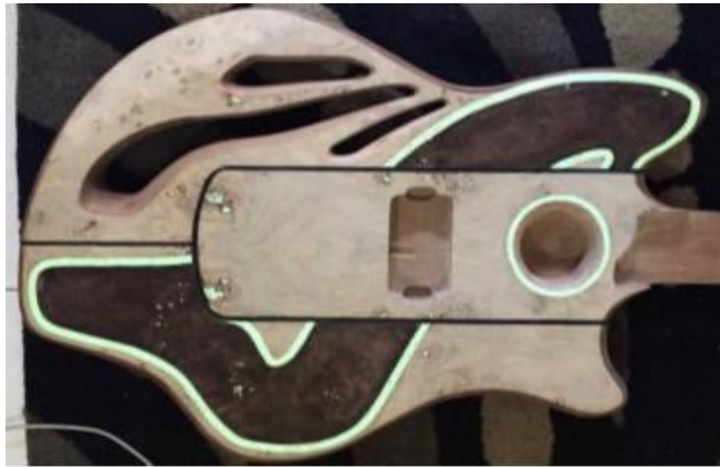
Gambar 5.0.36 Modul bodi gitar setelah ditanam garis resin phosphor dan cat open grain (Sumber : Penulis, 2020)
