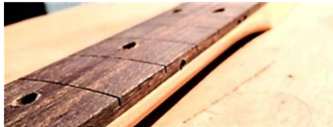
Gambar 5.0.26 Pelubangan dot inlay dan fret line (Sumber : Penulis, 2020)
