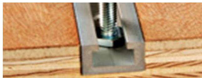
Gambar 5.0.32 Sistem rel T-Slot pada umumnya (Sumber : Penulis, 2020)
