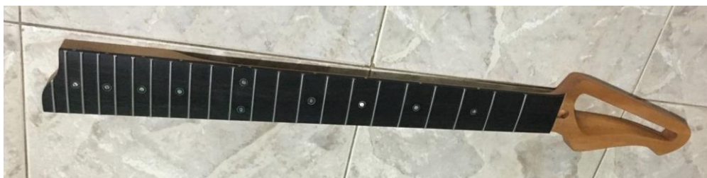
Lampiran 38 Hasil akhir neck gitar sebelum assembly (Sumber : Penulis, 2020)
