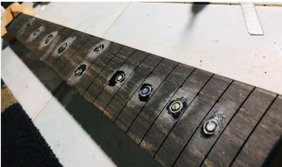
Lampiran 37 Penanaman resin fosfor pada dot inlay neck (Sumber : Penulis, 2020)
