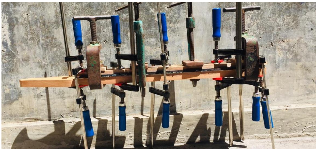
Lampiran 35 Proses clamp pada neck gitar (Sumber : Penulis, 2020)
