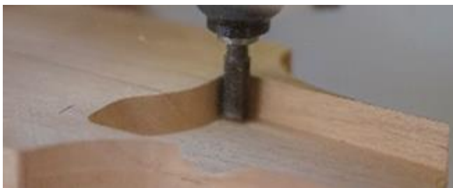
Gambar 5.0.30 Proses CNC bodi gitar bentuk dasar 3 axis (Sumber : Penulis, 2020)
