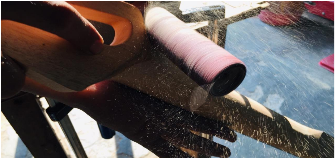
Lampiran 33 proses amplas kasar pada neck . (Sumber : Penulis, 2020)
