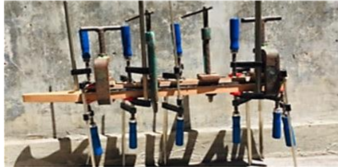
Gambar 5.0.25 Proses clamp pada neck gitar (Sumber : Penulis, 2020)
