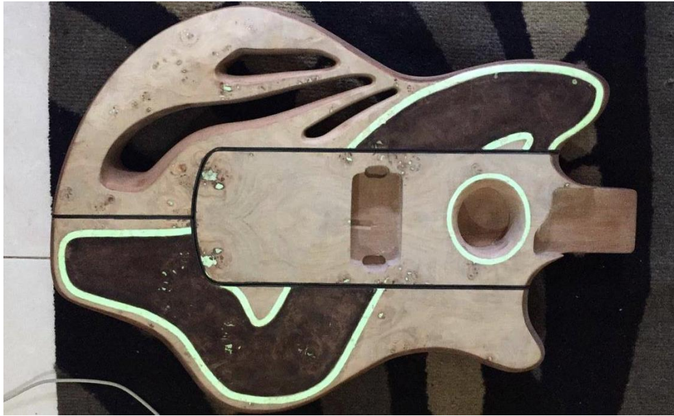
Lampiran 43 Modul bodi gitar setelah ditanam garis resin fosfor dan cat open grain (Sumber : Penulis, 2020)
