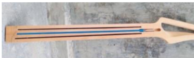
Gambar 5.0.23 Pengamplasan awal pada neck gitar (Sumber : Penulis, 2020)
