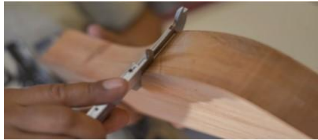
Gambar 5.0.31 Pengukuran kontur samping dengan jangka sorong (Sumber : Penulis, 2020)
