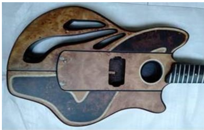
Gambar 5.0.37 Modul gitar setelah di finishing menggunakan polyurethane (Sumber : Penulis, 2020)
