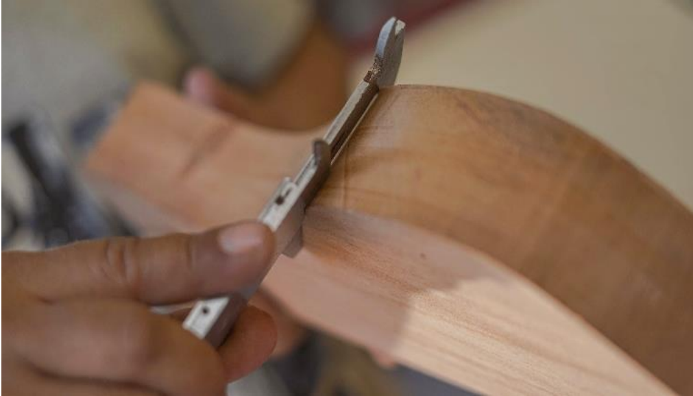
Lampiran 41 Pengukuran kontur samping dengan jangka sorong (Sumber : Penulis, 2020)
