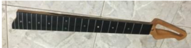
Gambar 5.0.28 Hasil akhir neck gitar sebelum assembly (Sumber : Penulis, 2020)
