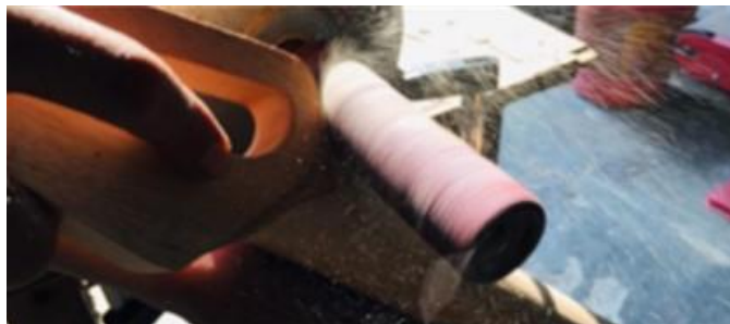
Gambar 5.0.23 Pengamplasan awal pada neck gitar (Sumber : Penulis, 2020)
