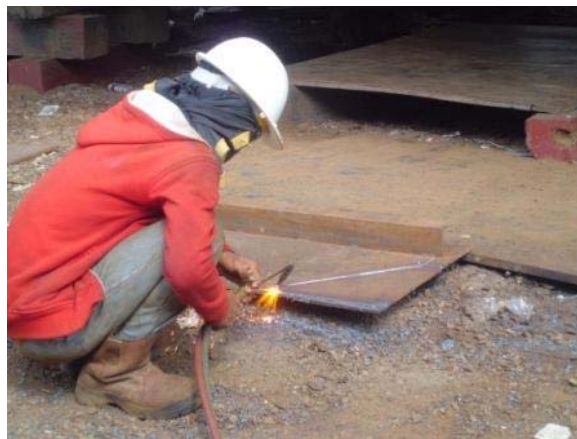
Gambar 4.4 Proses Pemotongan Pelat secara Manual
