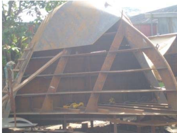
Gambar 4.5 Hasil Pekerjaan Bending daerah Haluan Kapal Tug Boat
