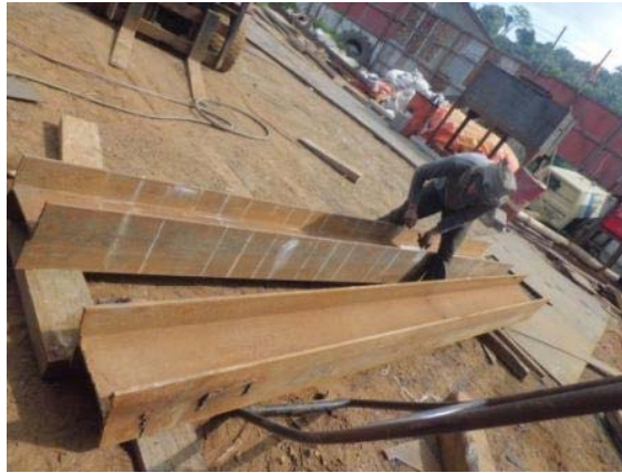
Gambar 4.3 Marking secara manual
