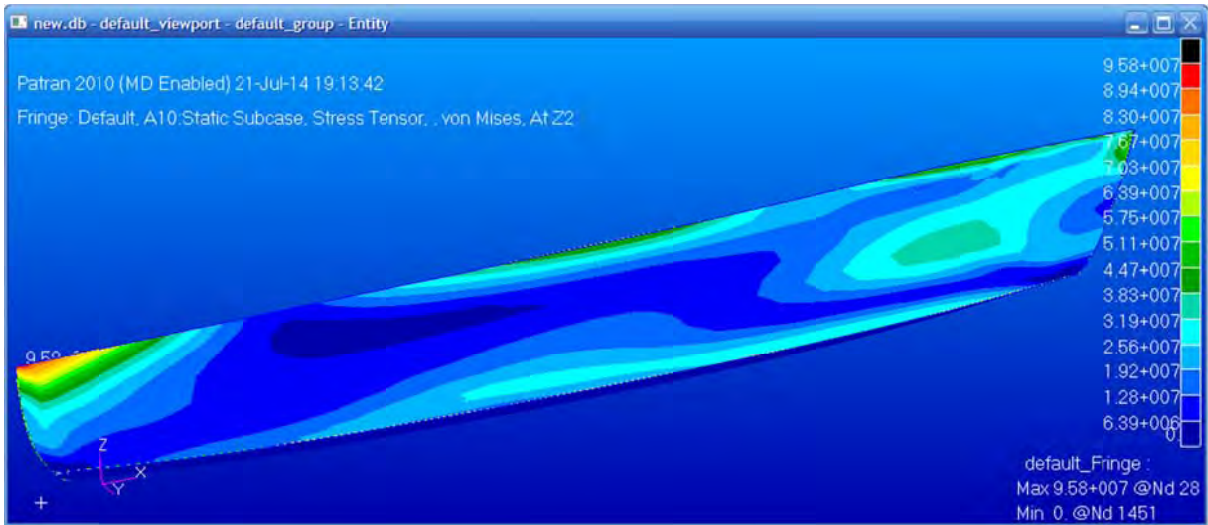
Gambar Hasil Analisis Kapal Perikanan 40 GT Berbahan Bambu Laminasi Ori
