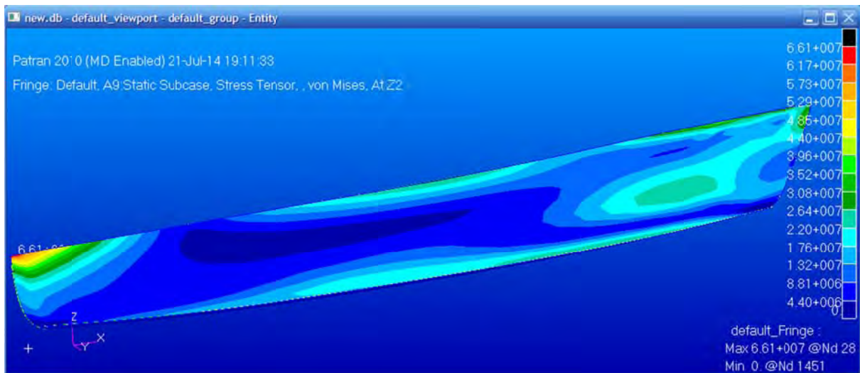
Gambar Hasil Analisis Kapal Perikanan 30 GT Berbahan Bambu Laminasi Ori
