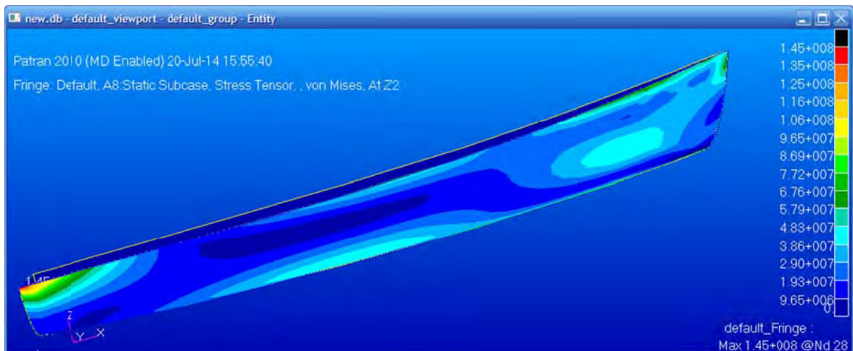
Gambar Hasil Analisis Kapal Perikanan 50 GT Berbahan Bambu Laminasi Betung
