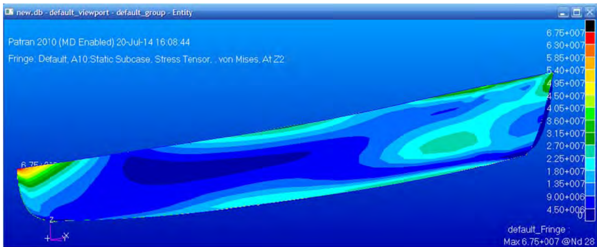
Gambar Hasil Analisis Kapal Perikanan 60 GT Berbahan Bambu Laminasi Betung
