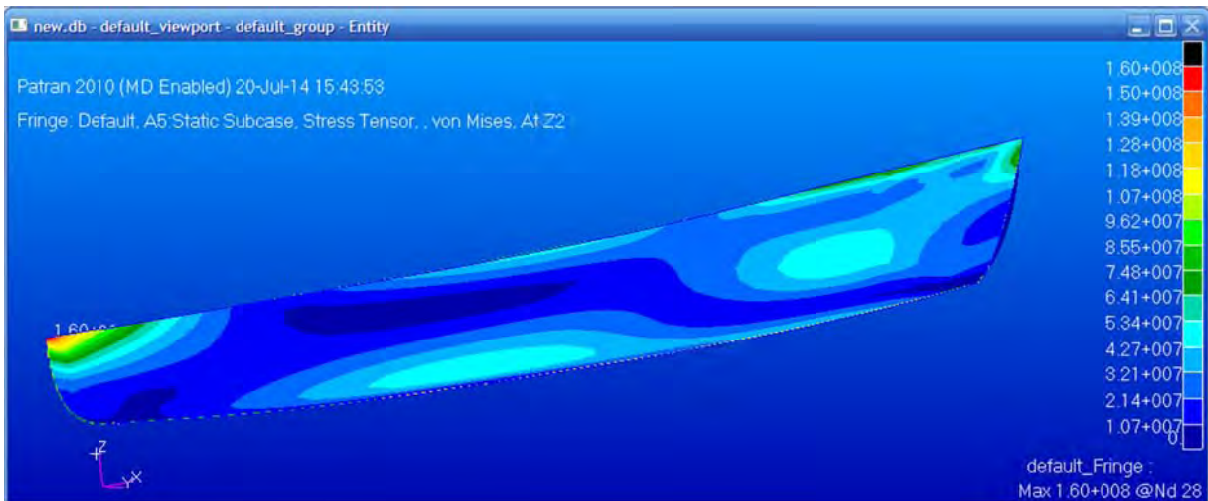
Gambar Hasil Analisis Kapal Perikanan 40 GT Berbahan Bambu Laminasi Betung
