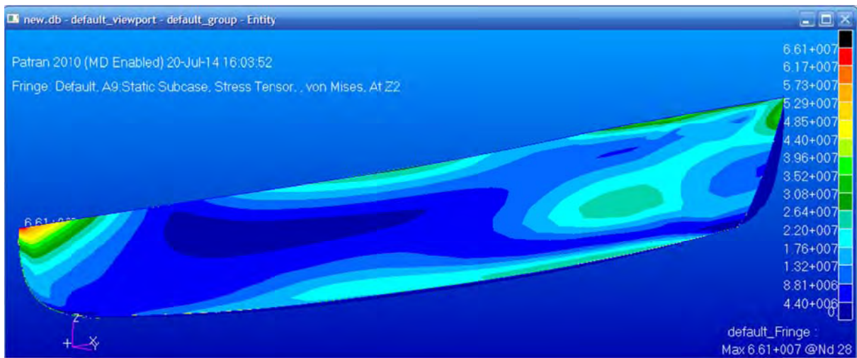
Gambar Hasil Analisis Kapal Perikanan 60 GT Berbahan Bambu Laminasi Ori
