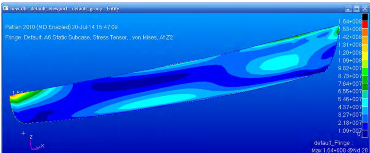
Gambar Hasil Analisis Kapal Perikanan 40 GT Berbahan Bambu Laminasi Betung
