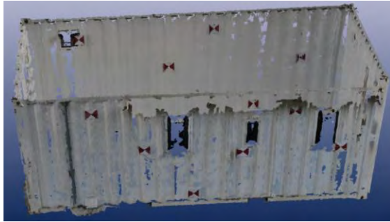
Gambar 4.16 Hasil Dense Surface Modelling Untuk Pembentukan Point Cloud
