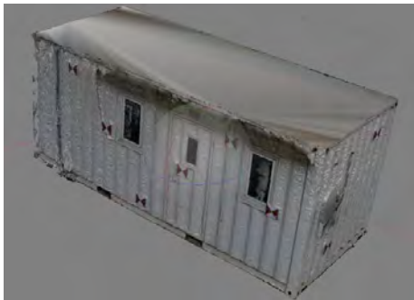
Gambar 4.20 Hasil Pembentukan Point Cloud Setelah Melakukan Proses Editing
