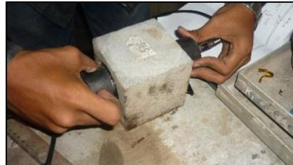
**Gambar 3. 13.** Pengujian UPV
