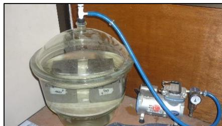
Gambar 3. 12. Uji Porositas Beton
