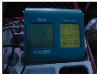
**Gambar 3. 14.** Hasil UPV di monitor alat tes
