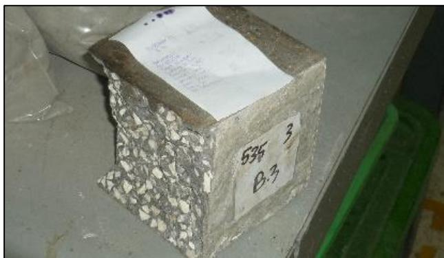
Gambar 3. 16. Beton kondisi setelah di uji kuat tekan
