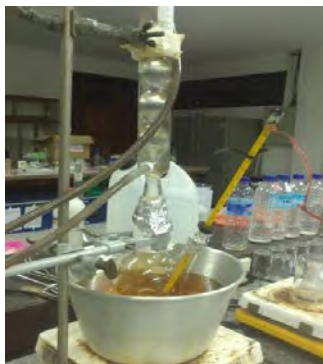
Gambar 4.2 Rangkaian alat refluks depolimerisasi PET
