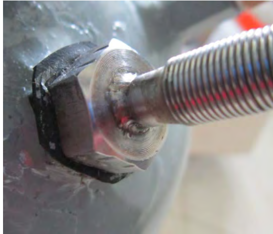
Gambar 4.7 Pemasangan termokopel pada tabung kalibrasi.
