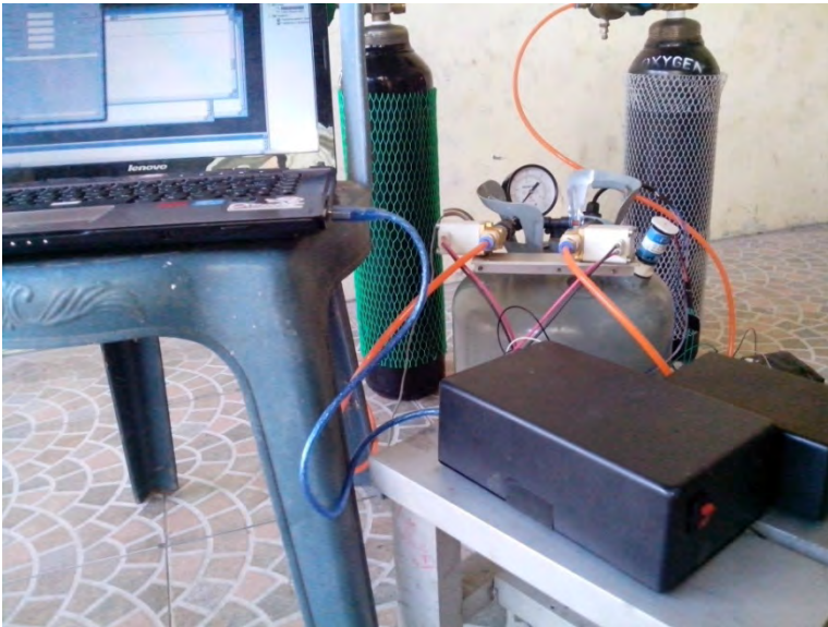
Gambar 4.14. Sambungan kabel mikrokontroler dan komputer
