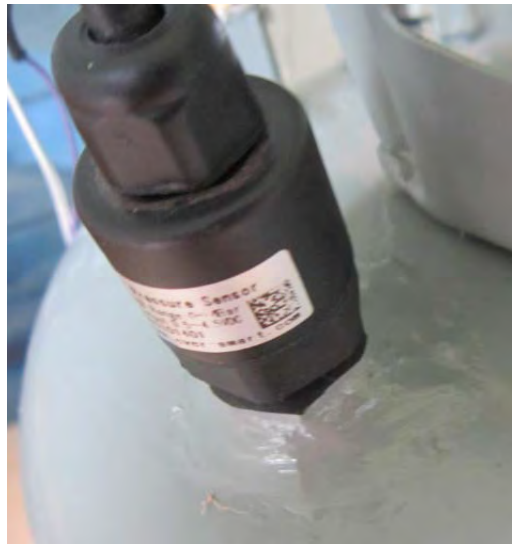
Gambar 4.6 Pemasangan sensor tekanan pada tabung kalibrasi.
