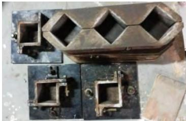
Gambar 6. Cetakan benda uji
