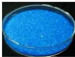
Gambar 4.4 Limbah buatan  $\text{CuSO}_4$  dan kristal  $\text{CuSO}_4 \cdot 5\text{H}_2\text{O}$
