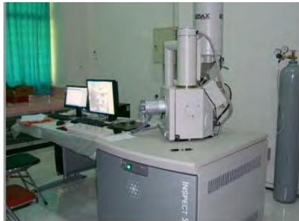
**Gambar 3.2** Seperangkat Peralatan Uji SEM
