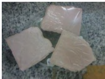
Gambar 4.3. Membran mentah hasil proses inversi fasa.
