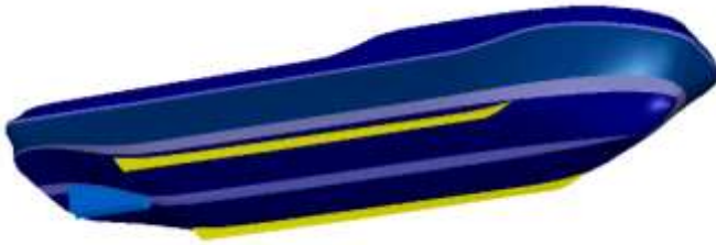
Gambar 2.3 Ilustrasi penempatan fins pada area bawah lambung kapal
