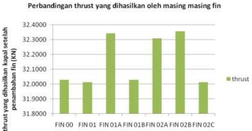
Gambar 4.11 Grafik Hubungan antara variasi bentuk Fin dengan perubahan nilai thrust kapal.
