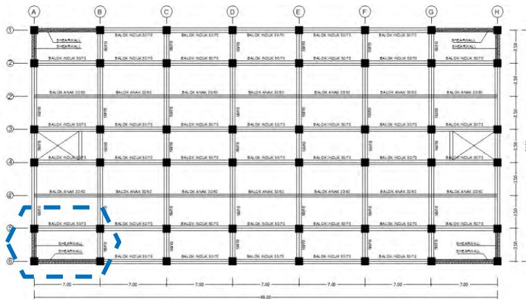
Gambar 7.21 Denah Penempatan Shearwall
