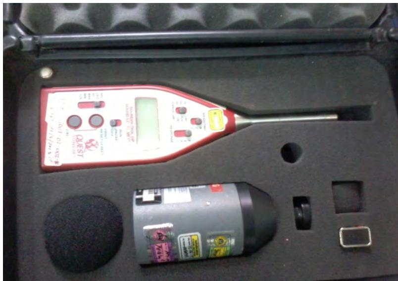
Gambar 2.1 *Sound Level Meter*<sup>[2]</sup>
