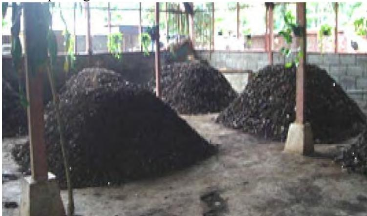
**Gambar 4.13 Pengomposan dengan Metode Aerobic Open Windrow (Balai Teknik Air Minum dan Sanitasi Wilayah 2, 2010)**
