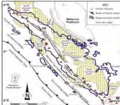
Gambar 4.17 Sistem sesar yang ada di Sumatera, SFZ, MFZ dan zona subduksi ([geologi.iagi.or.id](http://geologi.iagi.or.id)).
