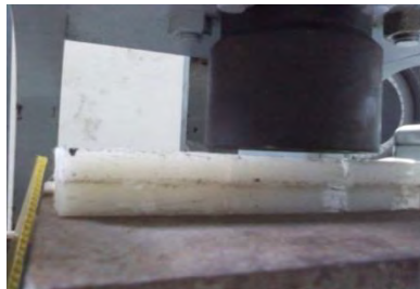
Gambar 3.6. Pengujian pembebanan menggunakan alat uji tekan beton
