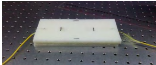
Gambar 3.7. Desain sensor beban yang telah diberi tanda di bagian tengah
