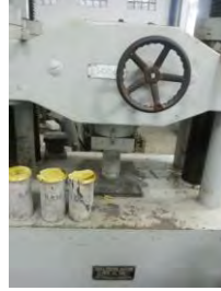
pengujian kuat tekan beton
