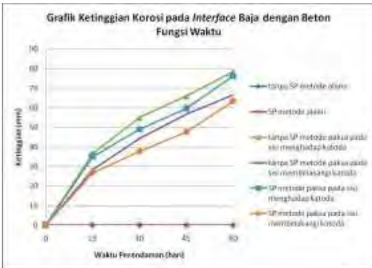
Gambar 4.8 Grafik ketinggian air pada interface baja dengan beton fungsi waktu
