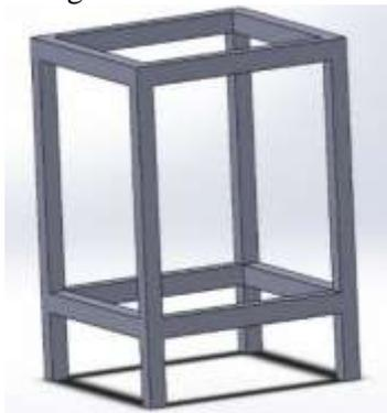
**Gambar 7.8** Kerangka tungku kukus
