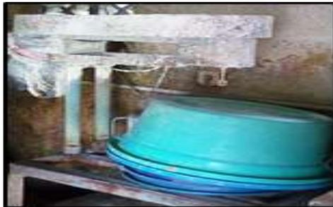
Gambar 2.2 Mesin pencampur tepung
