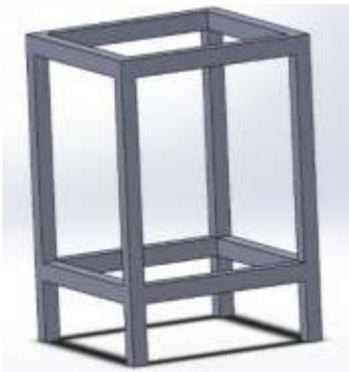
**Gambar 7.8** Kerangka tungku kukus
