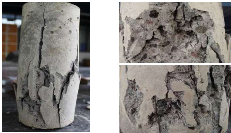
Gambar 4.7 Pola retak spesimen pengujian uniaxial compression , beton polos dan beton dengan tambahan serat.
