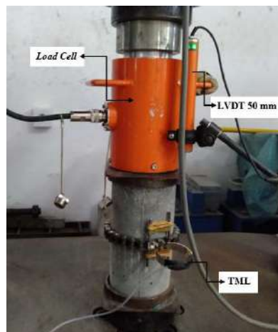
Gambar 3. 4 Desain pengujian silinder
