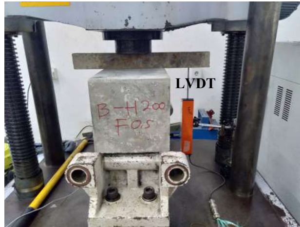
Gambar 3.8 Pengujian three bending point dengan instrumen LVDT vertikal
