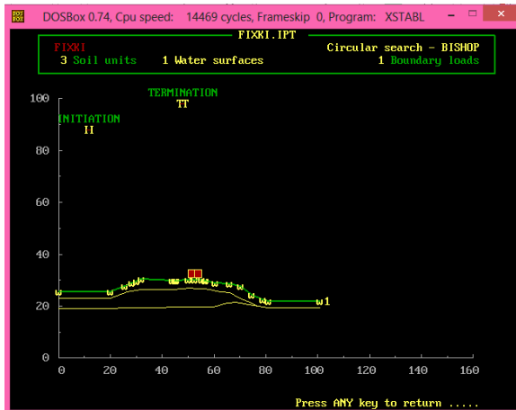
Gambar 4.7 Pemodelan Geometri Lereng Sisi Kiri Tower PLN T.09 (Segoromadu – Petrokimia Gresik) dengan Program Bantu DxStable
