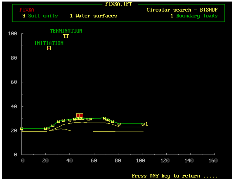
Gambar 5.3 Posisi Muka Air pada Permukaan Lapisan Tanah Paling Atas Talud Sisi Kanan
