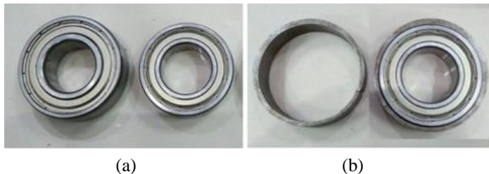
Gambar 3.8 (a) bearing Normal (b) bearing untuk keadaan eksentrisitas
