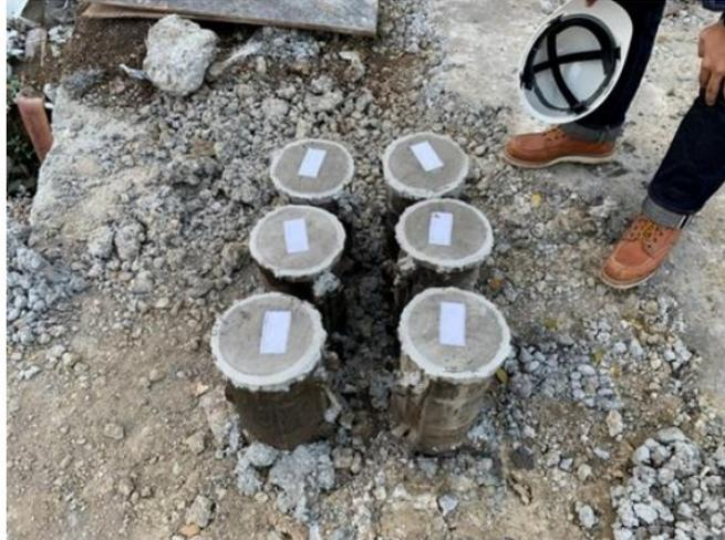
**Gambar 3. 12** Cetakan Benda Uji Beton Silinder
